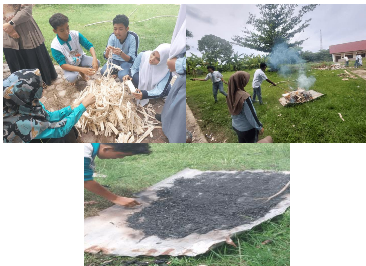
Gambar 4. Tahap Pembakaran Ampas Tebu Menjadi Arang
