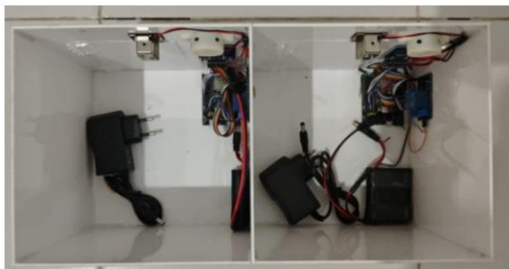
Gambar 14. Tampak Dalam Prototype Alat Smart Door Lock
