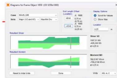
Gambar 21. Diagram Moment Balok Pada Frame 1859
